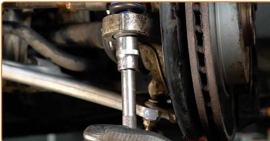
Serrez l'écrou de fixation reliant l'embout de biellette de direction à la fusée d'essieu. Utilisez une douille n° 18. Utilisez une clé dynamométrique. Serrez-le jusqu'à 70 Nm.
