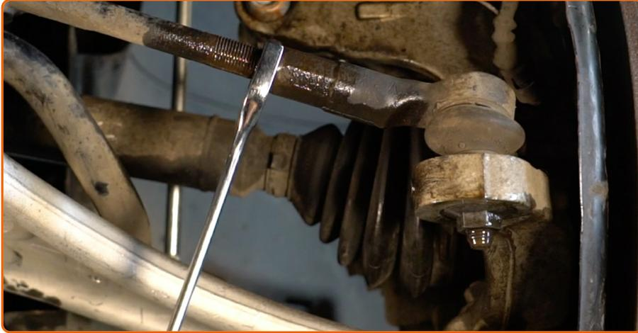
Désérrez l'écrou de blocage qui retient l'extrémité de la barre stabilisatrice à la barre stabilisatrice. Utilisez une clé mixte de No.24
