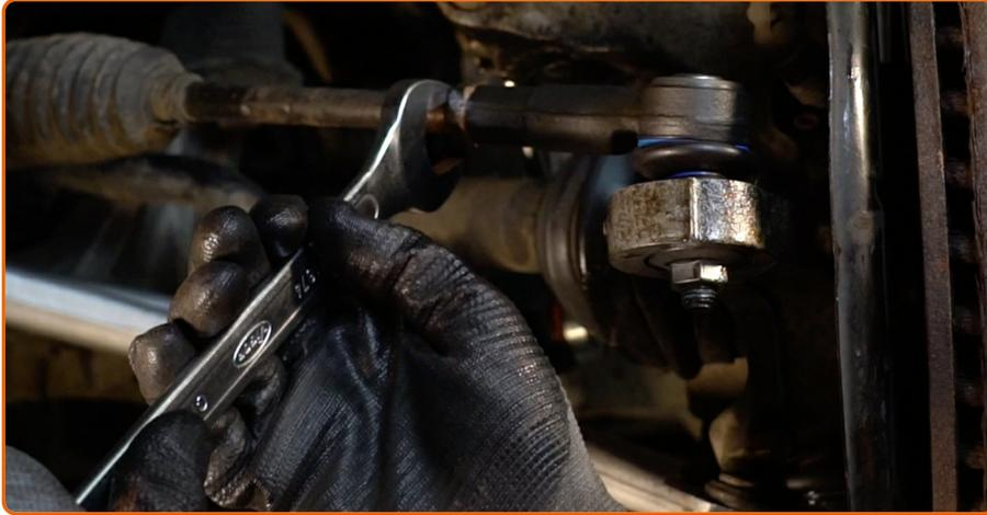
Vissez le contre-écrou de l'embout de biellette de direction. Utilisez une clé mixte de No.22
