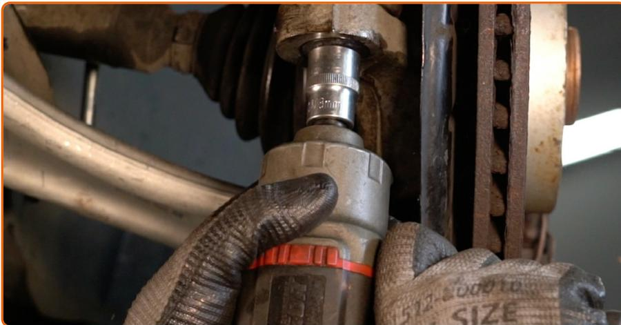
Dévissez l'écrou d'attache d'extrémité à la fusée d'essieu. Utilisez une douille n° 18. Utilisez un porte-taraud.
