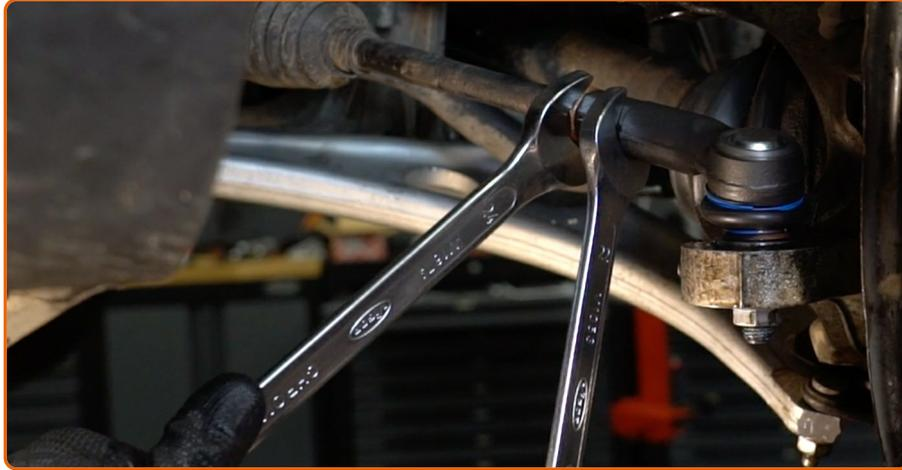
Serrez l'écrou de blocage de l'extrémité de la barre. Utilisez une clé mixte de No.22 Utilisez une clé mixte de No.24 Utilisez une clé dynamométrique. Serrez-le jusqu'à 50 Nm.
