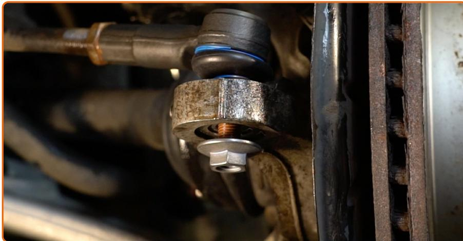
Vissez l'écrou de fixation reliant l'embout de biellette à la fusée d'essieu. Utilisez une douille n° 18. Utilisez une clé à cliquet.
