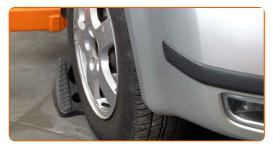
Desserrez les boulons de fixation de la roue. Servez-vous d'une douille à choc pour roue N°17.
