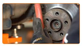
Appliquez du produit sur la zone de contact entre le disque de frein et la jante. Utilisez de la graisse au cuivre.
