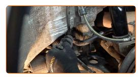
13 Installez les nouvelles silentblocs de barre stabilisatrice.
