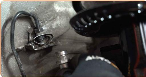
**14** Vissez le tuyau de frein sur la conduite du circuit de frein. Utilisez une clé mixte de No.11 Utilisez une clé dynamométrique. Serrez-le jusqu'à 15 Nm.
