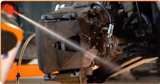
Remplacement : flexible de frein – Skoda Fabia 6Y5. AUTODOC recommande :
