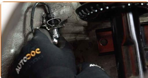
**15** Serrez la fixation reliant la conduite de freinage à l'étrier de frein. Utilisez une douille n° 11. Utilisez une clé dynamométrique. Serrez-le jusqu'à 30 Nm.
