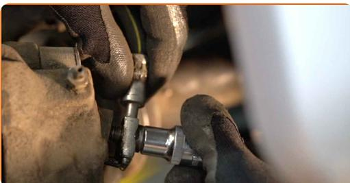
**12** Dévissez la connexion reliant le tuyau de frein à la conduite du circuit de frein. Utilisez une clé mixte de No.11
