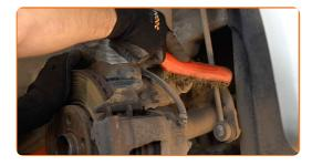
Dévissez l'écrou et retirez la barre stabilisatrice de l'entretoise de l'amortisseur. Utilisez une clé mixte de No.16. Utilisez la clé HEX n° H5. Utilisez une clé à cliquet.
