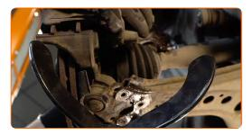
Dévissez les fixations qui lient l'arbre de transmission au moyeu de roue. Servez-vous d'une douille 12 pans N°36.
