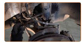
Relâchez la fixation inférieure assurant la connexion entre la jambe d'amortisseur et le porte-fusée. Servez-vous d'une douille spéciale pour retirer l'amortisseur. Utilisez une clé à cliquet.
