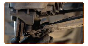
Serrez l'attache du joint rotule. Utilisez une douille n° 13. Utilisez une clé dynamométrique. Serrez-le jusqu'à 20 Nm.+90°
