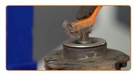
Retirez l'écrou de la tige de piston de l'entretoise. Utilisez une clé mixte de No.21. Utilisez la clé HEX n° H7. Utilisez une clé à cliquet.
