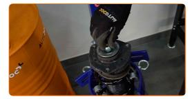
Serrez l'écrou de l'entretoise d'amortisseur due la tige de piston. Utilisez une clé mixte de No.21. Utilisez la clé HEX n° H7. Utilisez une clé dynamométrique. Serrez-le jusqu'à 60 Nm.
