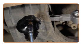
Vissez la fixation du support moteur qui le relie au carter de la boîte de vitesses. Utilisez une douille n° 16. Utilisez une clé à cliquet.
