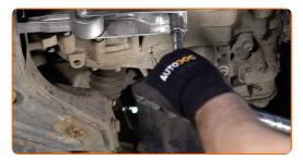
13.2 Utilisez une douille n° 16. Utilisez une clé dynamométrique. Serrez-le jusqu'à 40 Nm.+90°
