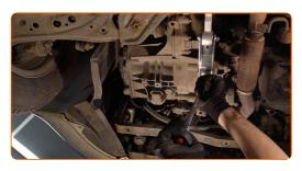
13.1 Serrez les écrous de fixation du support moteur.
