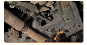
Dévissez la fixation reliant le support du moteur au carter de la boîte de vitesses. Utilisez une douille n° 16. Utilisez une clé à cliquet.
