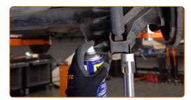
Dévissez l'attache inférieure de l'amortisseur. Utilisez une clé mixte de No.16. Utilisez une douille n° 16. Utilisez une clé à cliquet.
