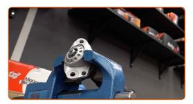
Vissez l'attache supérieure de la tige de piston de l'amortisseur. Utilisez une clé mixte de No.17. Servez-vous d'une clé ajustable. Utilisez une clé dynamométrique. Serrez-le jusqu'à 25 Nm.
