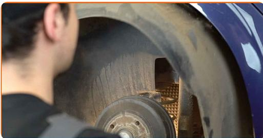
**8** Détachez la fixation du couvercle plastique de protection de l'essieu arrière.
