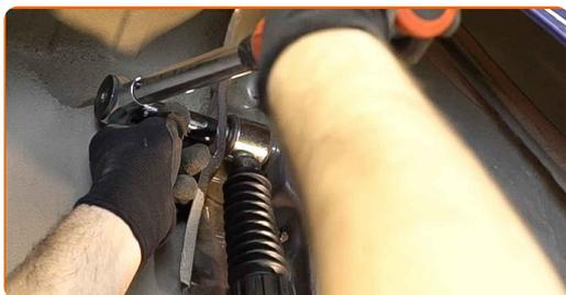
**20** Serrez l'attache inférieure de l'amortisseur. Utilisez une douille n° E18. Utilisez une clé dynamométrique. Serrez-le jusqu'à 100 Nm.
