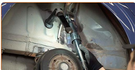
**18** Installez les boulons de fixation.
