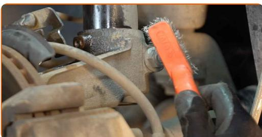
**19** Dévissez l'attache inférieure du support de l'amortisseur. Utilisez une douille n° 18. Servez vous de la douille XZN n°12. Utilisez un porte-taraud. Utilisez une clé à cliquet.
