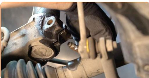
**21** Retirez l'écrou de fixation. Utilisez une douille n° 24.
