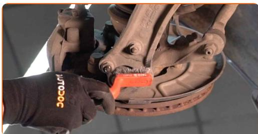
**24** Dévissez les fixations qui lient le joint à rotule au bras de contrôle de suspension. Utilisez une douille n° 16. Utilisez un porte-taraud.
