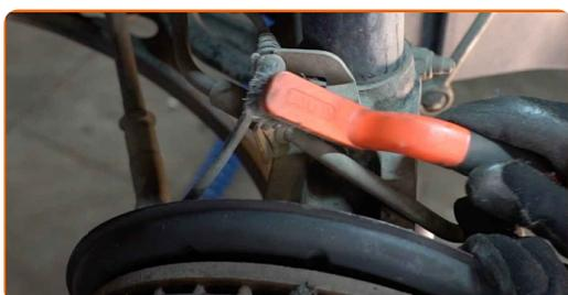
**17** Dévisser le boulon et retirer le support du flexible de frein ainsi que le câble ABS. Utilisez une clé mixte de No.11
