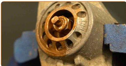
**27** Installez le bouchon de protection sur le support de l'amortisseur.
