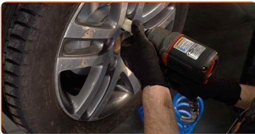
**30** Abaissez la voiture et serrez les boulons de roue en ordre croisé. Utilisez une clé dynamométrique. Serrez-le jusqu'à 120 Nm.
