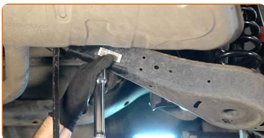
**20** Installez l'écrou de fixation.
