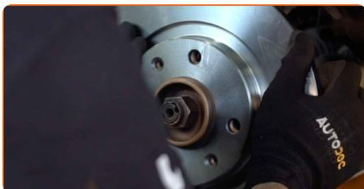
**20** Serrez l'attache du disque de frein. Utilisez la mèche Torx T30. Utilisez une clé dynamométrique. Serrez-le jusqu'à 9 Nm.
