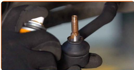
**15** Connectez l'extrémité du tirant à la fusée d'essieu.
