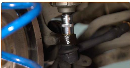
**17** Vissez le contre-écrou de l'embout de biellette de direction. Utilisez une clé mixte de No.22 (2 pièces).
