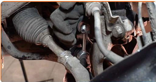
**47** Serrez la fixation reliant la biellette de barre stabilisatrice à la fourchette d'amortisseur. Utilisez une clé mixte de No.18. Utilisez la clé HEX n° H6. Utilisez une clé dynamométrique. Serrez-le jusqu'à 60 Nm.
