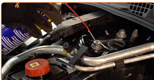
**4** Dévissez la fixation supérieure du support d'amortisseur. Utilisez une douille n° 16. Utilisez une clé à cliquet.
