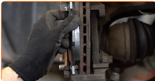
Remplacement : plaquettes de frein – Ford Focus MK2. Les professionnels recommandent :
