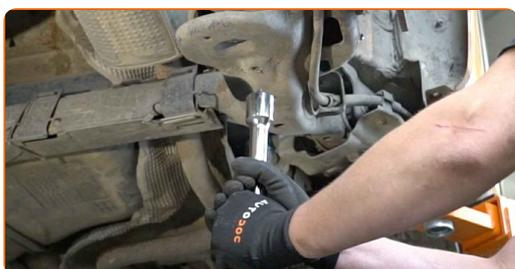
Remplacement : amortisseur – Peugeot 207 3 ou 5 portes. Les professionnels recommandent :
