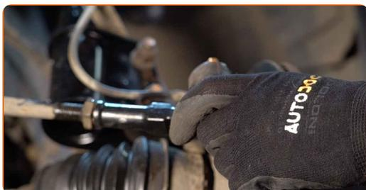
**18** Vissez l'écrou de fixation reliant l'embout de biellette à la fusée d'essieu. Utilisez une douille n° 17.
