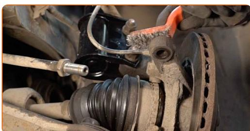
**15** Appliquez du produit sur la partie filetée de la biellette de direction. Utilisez de la graisse au cuivre.
