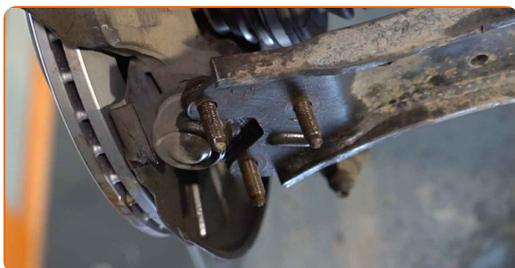
**40** Vissez la fixation reliant le joint à rotule au bras de commande. Utilisez une douille n° 16. Utilisez une clé à cliquet.
