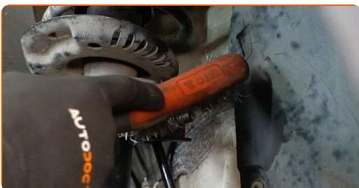
**8** Dévissez la fixation reliant la biellette à l'amortisseur. Utilisez une douille n° 19. Utilisez une clé à cliquet.
