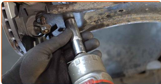
**41** Installez le boulon de l'arbre de transmission et serrez-le. Utilisez une douille n° 27. Utilisez une clé à cliquet.
