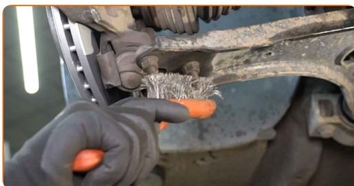
**12** Dévissez les fixations qui lient le joint à rotule au bras de contrôle de suspension. Utilisez une douille n° 16. Utilisez une clé à cliquet.
