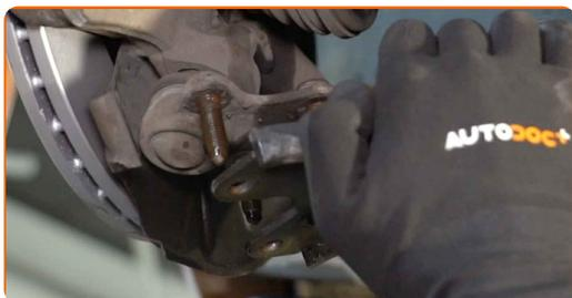
**14** Détachez l'arbre de transmission de la fusée d'essieu.
