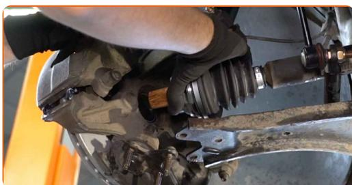
**39** Attachez le joint à rotule au bras de contrôle.
