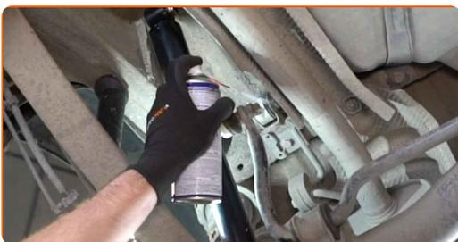
**7** Dévissez les écrous de fixation du support reliant la barre stabilisatrice à la carrosserie. Utilisez une clé mixte de No.18
