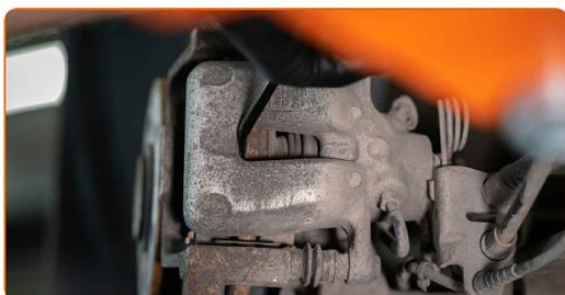
**7** Débranchez le capteur électrique d'ABS. Déconnectez le connecteur du capteur d'usure de plaquette de frein. Retirez le raccord du capteur ABS. Retirez le raccord du palpeur d'usure de la plaquette de frein. Servez-vous de pinces à bout rond.
