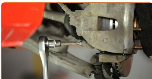
**35** Installez les bouchons anti-poussière des goupilles de guidage de l'étrier de frein.
