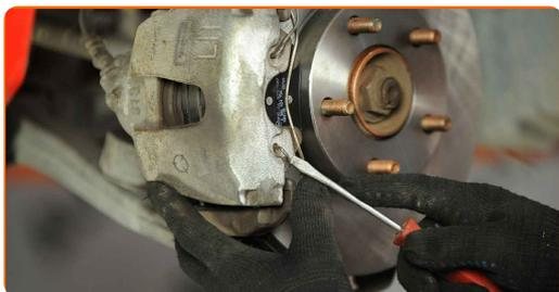
**37** Appliquez du produit sur la zone de contact entre le disque de frein et la jante. Utilisez de la graisse au cuivre.
