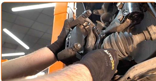
**25** Installez les boulons de fixation (2 pièces).
