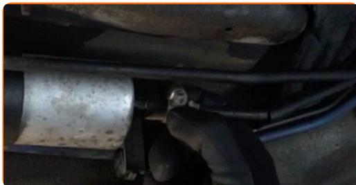
9 Dévissez le support du filtre à carburant. Utilisez une douille n° 10. Utilisez une clé à cliquet.
