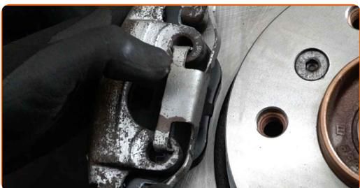
**21** Serrez les fixations de l'étrier de frein. Utilisez la clé HEX n° H7. Utilisez une clé dynamométrique. Serrez-le jusqu'à 30 Nm.
