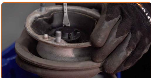
**23** Retirez l'écrou de la tige de piston de l'entretoise. Utilisez une douille n° 22. Utilisez la clé HEX n° H7.
