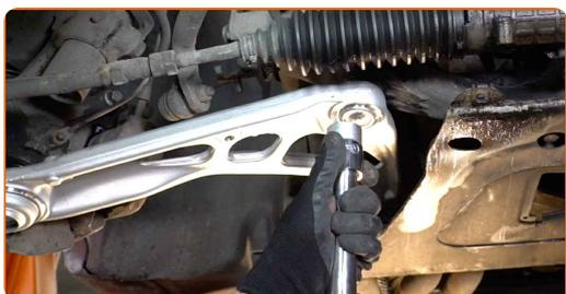
Remplacement : bras inférieur avant – BMW E46 cabriolet. AUTODOC recommande :
