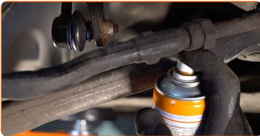
16 Nettoyez le siège de fixation de la jante. Utilisez une brosse métallique. Traitez la surface de contact. Utilisez de la graisse au cuivre.
