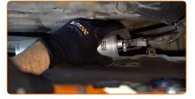
Serrez l'attache de la ligne d'alimentation en carburant. Utilisez un tournevis plat.
