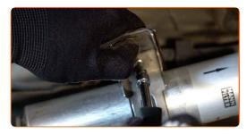
Serrez les attaches du filtre à carburant. Utilisez une douille n° 13. Utilisez une clé à cliquet.
