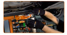
Dévissez les fixations du support du filtre à essence. Utilisez la mèche Torx T20. Utilisez une clé à cliquet.
