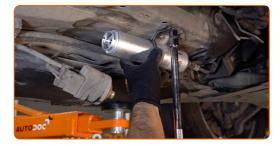
Attachez le régulateur de pression d'essence au filtre à huile. Installez l'anneau d'arrêt du clip de retenue au régulateur de pression d'essence.
