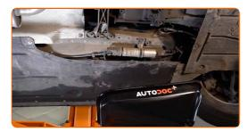
Lubrifiez les fixations qui relient les tuyaux au filtre à carburant. Servez-vous d'un aérosol nettoyant multi-usages.
