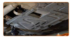
Serrez les boulons de fixation du couvercle de protection. Utilisez une douille n° 8. Utilisez une clé à cliquet.
