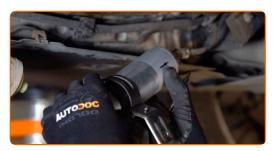
Serrez la fixation du support du filtre à essence. Utilisez la mèche Torx T20. Utilisez une clé à cliquet.
