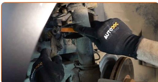
**12** Installez une nouvelle barre, serrez les attaches.
