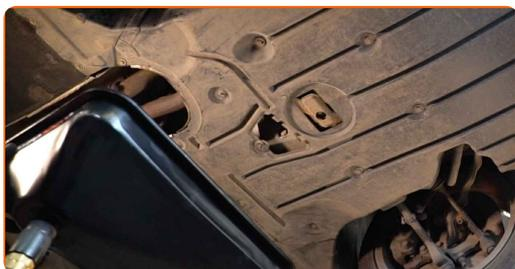
**13** Dévissez le bouchon de vidange. Utilisez une douille n° 17. Utilisez une clé à cliquet.
