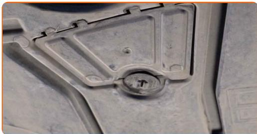
**19** Vissez la fixation du panneau d'accès au bouchon de vidange. Utilisez un tournevis plat.
