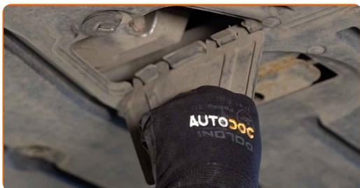
**12** Placez un contenant d'huile de vidange d'une capacité de 7 l minimum sous l'orifice de drainage.
