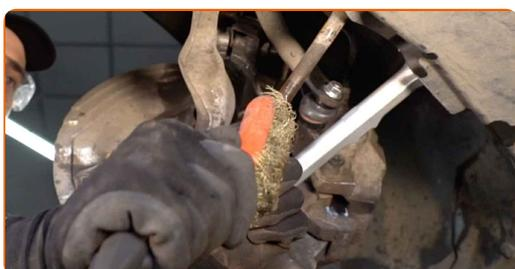
**13** Appliquez du produit sur les emplacements de montage de l'embout de biellette. Utilisez de la graisse au cuivre.
