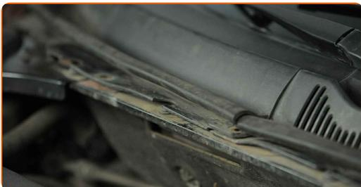
**8** Vissez les fixations de la grille d'auvent situées du côté droit. Utilisez la mèche Torx T30. Utilisez une clé à cliquet.
