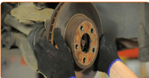
**18** Nettoyez le moyeu. Utilisez une brosse métallique. Traitez la surface de contact. Utilisez de la graisse au cuivre.
