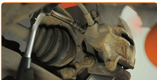
**32** Appliquez du produit sur la zone de contact entre le disque de frein et la jante. Utilisez de la graisse au cuivre.
