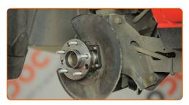
Serrez le moyeu. Utilisez la mèche Torx T50. Utilisez une clé dynamométrique. Serrez-le jusqu'à 70 Nm.
