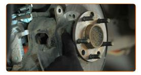
Retirez le moyeu et le roulement puisqu'ils forment un bloc hermétique.
