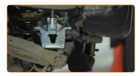
Dévissez l'attache du support d'étrier. Utilisez une douille n° 13. Utilisez une clé à cliquet.
