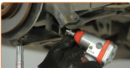
**16** Serrez l'attache de l'amortisseur supérieur. Utilisez une clé mixte de No.18. Utilisez une douille n° 15. Utilisez une clé dynamométrique. Serrez-le jusqu'à 84 Nm.
