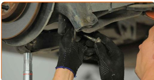
**15** Serrez l'attache inférieure de l'amortisseur. Utilisez une douille n° 18. Utilisez une clé dynamométrique. Serrez-le jusqu'à 120 Nm.
