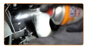
Dévissez le bouchon du compartiment du filtre, ainsi que l'ancien élément filtrant. Utilisez une douille n° 27. Utilisez une clé à cliquet.
