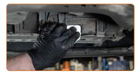
Vissez le nouveau bouchon de vidange et le resserrez. Utilisez la mèche Torx T45. Utilisez une clé dynamométrique. Serrez-le jusqu'à 30 Nm.
