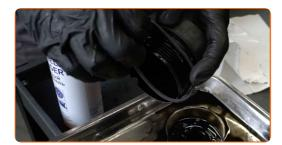
Installez les nouveaux filtres à huile sur les sièges de montage sur le couvercle du filtre.
