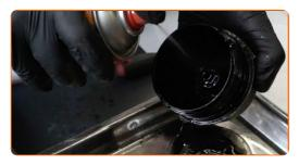
Installez une nouvelle bague d'étancheité sur l'emplacement du filtre à huile.
