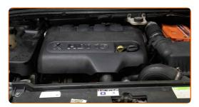
Vérifiez le niveau d'huile cinq minutes après l'arrêt du moteur à l'aide d'une jauge, et ajoutez de l'huile si nécessaire.
