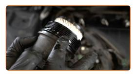
Installez un nouveau couvercle de compartiment à filtre à huile, et serrez. Utilisez une douille n° 27. Utilisez une clé dynamométrique. Serrez-le jusqu'à 25 Nm.
