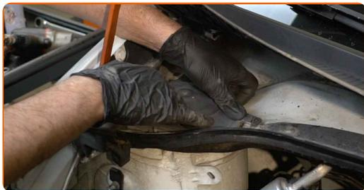
**71** Vissez les fixations du couvercle du support de la jambe de suspension. Utilisez une douille n° 10. Utilisez une clé à cliquet.
