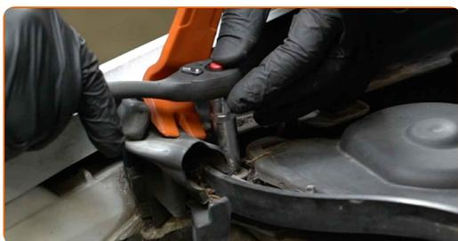
**7** Retirez le bouchon de protection du support d'amortisseur.
