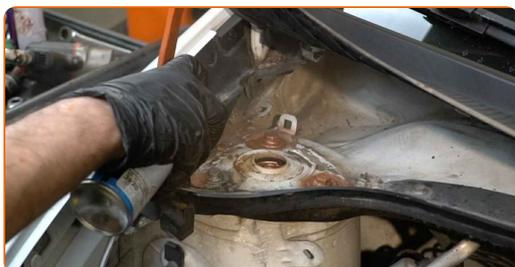
**70** Installez le bouchon de protection du support d'amortisseur.
