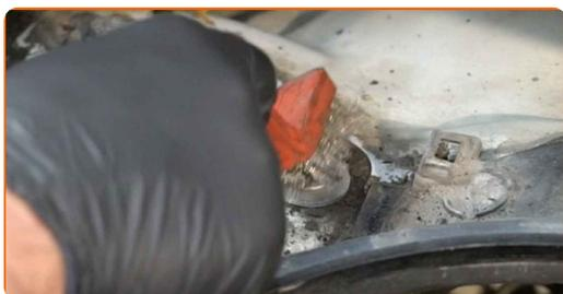
**9** Devissez la fixation supérieure du support d'amortisseur. Utilisez une douille n° 13. Utilisez une clé à cliquet.
