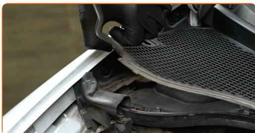
**6** Dévissez les fixations du couvercle du support de la jambe de suspension. Utilisez une douille n° 10. Utilisez une clé à cliquet.
