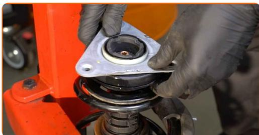
**43** Serrez l'écrou de l'entretoise d'amortisseur due la tige de piston. Utilisez une douille n° 18. Utilisez la clé HEX n° H6. Utilisez une clé dynamométrique. Serrez-le jusqu'à 62 Nm.
