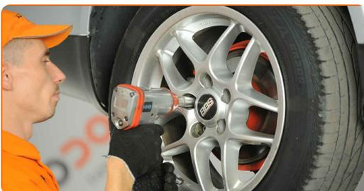
**31** Abaissez la voiture et serrez les boulons de roue en ordre croisé. Utilisez une clé dynamométrique. Serrez-le jusqu'à 120 Nm.
