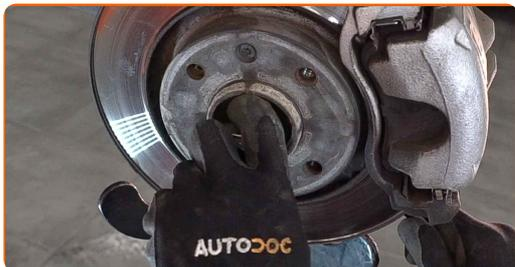
**68** Serrez le moyeu. Utilisez une douille n° 36. Utilisez une clé dynamométrique. Serrez-le jusqu'à 325 Nm.
