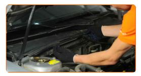
Retirez l'élément filtrant du compartment du filtre. Utilisez un tournevis plat.
