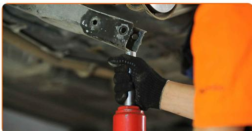
**20** Installez l'écrou de fixation. Servez-vous d'un poinçon effilé. Servez-vous d'un pied-de-biche. Utilisez une douille n° 21. Utilisez une clé à cliquet.
