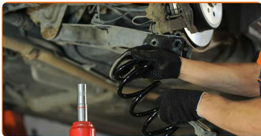
**18** Installez un nouveau ressort hélicoïdal avec ses supports en caoutchouc sur les emplacements de montage.
