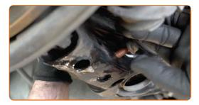
Serrez l'attache inférieure de l'amortisseur. Utilisez une clé mixte de No.18. Utilisez une douille n° 18. Utilisez une clé dynamométrique. Serrez-le jusqu'à 75 Nm.
