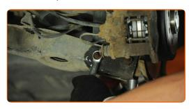
9 Retirez l'écrou de fixation.
