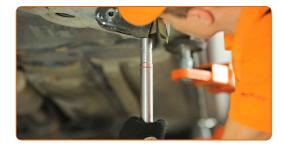
30 Installez l'écrou de fixation.
