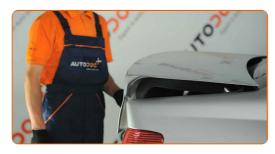
Retirez les attaches de la garniture latérale du coffre. Utilisez un outil d'extraction de clips.
