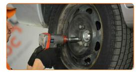
Abaissez la voiture et serrez les boulons de roue en ordre croisé. Servez-vous d'une douille à choc pour roue N°19. Utilisez une clé dynamométrique. Serrez-le jusqu'à 90 Nm.
