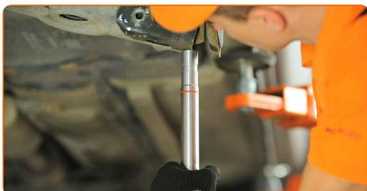
28 Installez l'écrou de fixation.
