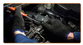
Desserrez les trois vis de fixation du couvercle de filtre à air. Servez-vous d'un tournevis Phillips.
