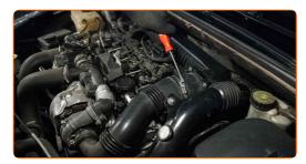
Retirez l'ensemble du boîtier de distribution d'air. Utilisez un tournevis plat.
