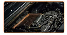
Retirez l'élément filtrant du compartment du filtre.
