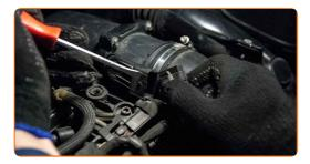
Serrez le collier de serrage sur la durite d'admission d'air. Utilisez un tournevis plat.
