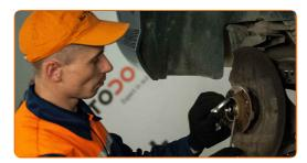
Dessertissez l'écrou de retenue du moyeu de roue. Servez-vous d'un burin plat pour l'usinage des métaux. Servezvous d'un marteau.
