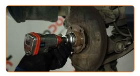
Retirez l'écrou de fixation.
