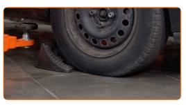
Desserrez les boulons de fixation de la roue. Servez-vous d'une douille à choc pour roue N°19.
