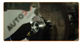
23 Installez l'écrou de fixation.
