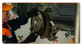
Serrez l'attache du disque de frein. Utilisez la mèche Torx T30. Utilisez une clé dynamométrique. Serrez-le jusqu'à 9 Nm.
