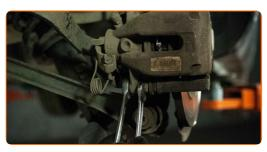
Appliquez du produit sur la zone de contact entre le disque de frein et la jante. Utilisez de la graisse au cuivre.
