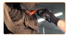
Dévissez l'attache du support d'étrier. Utilisez la mèche Torx T55. Utilisez une clé à cliquet.
