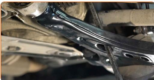
Remplacement : bras inférieur avant – VW Polo 9N. Les experts d'AUTODOC recommandent :
