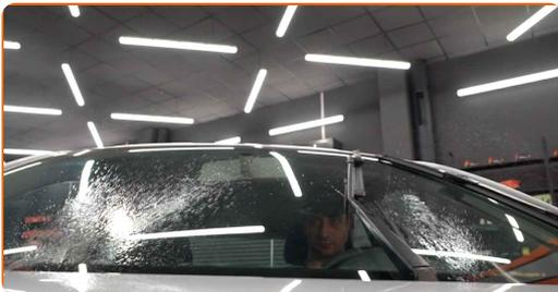
5 Après installation, vérifiez la performance des essuie-glaces. Les balais ne doivent pas s'entrechoquer ni cogner contre le joint du pare-brise.
