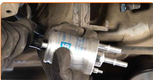
12 Serrez les attaches du filtre à carburant. Servez-vous d'un tournevis Phillips.
