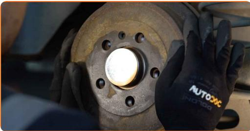
**18** Serrez les fixations des tambours de frein. Servez-vous d'un tournevis Phillips. Utilisez une clé dynamométrique. Serrez-le jusqu'à 4 Nm.
