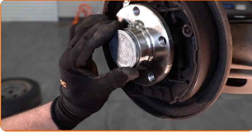
**16** Lubrifiez le moyeu à l'endroit où il est en contact avec le disque de frein. Utilisez de la graisse au cuivre.
