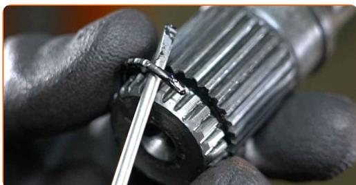
**32** Installez le soufflet du joint homocinétique sur le demi-arbre de transmission. Utilisez un tournevis plat.
