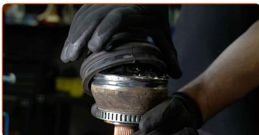
**30** Détachez le siège de montage du joint homocinétique. Servez-vous d'un aérosol nettoyant multi-usages.
