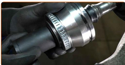
**36** Déplacez la bague intérieure du nouveau joint homocinétique d'un côté à l'autre pour qu'elle soit prête à fonctionner.
