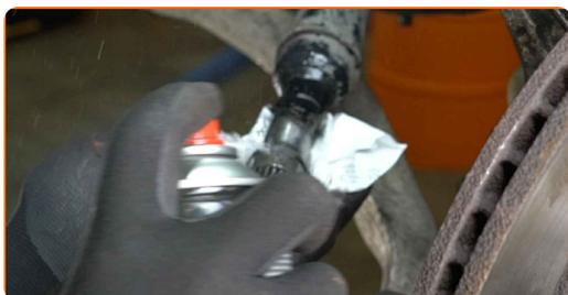
**31** Détachez le circlip du joint homocinétique. Utilisez un tournevis plat.
