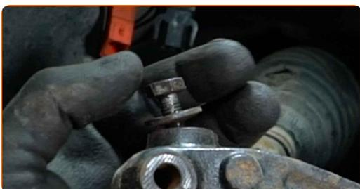
**16** Desserrez le boulon de fixation de l'extrémité de la biellette de direction. Utilisez une clé mixte de No.13
