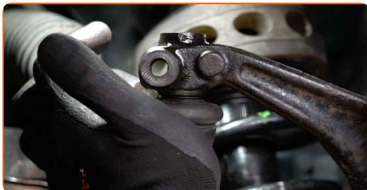
**42** Installez l'écrou de fixation.
