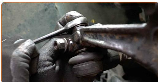
**44** Installez l'écrou de fixation.
