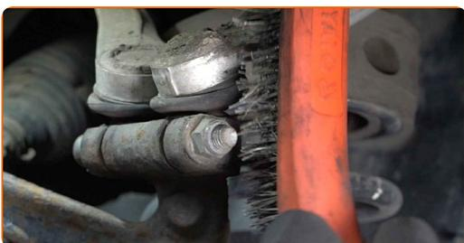
**12** Dévissez les attaches du bras supérieur. Utilisez une douille n° 16. Utilisez la clé HEX n° H8. Utilisez une clé à cliquet.
