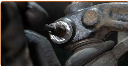
**14** Desserrez le boulon de fixation de l'extrémité de la biellette de direction. Utilisez une douille n° 13. Utilisez une clé à cliquet.
