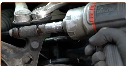
**13** Retirez l'écrou de fixation.
