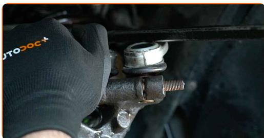
**49** Vissez les fixations des bras de commande supérieurs. Utilisez une douille n° 16. Utilisez la clé HEX n° H8. Utilisez une clé à cliquet.
