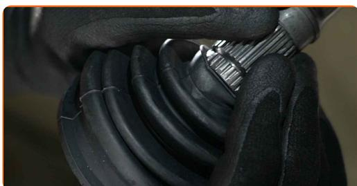
**33** Installez le circlip du joint homocinétique.
