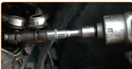
**50** Serrez les attaches du bras supérieur. Utilisez une douille n° 16. Utilisez la clé HEX n° H8. Utilisez une clé dynamométrique. Serrez-le jusqu'à 40 Nm.
