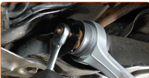
**21** Connectez le joint rotule à la fusée d'essieu.
