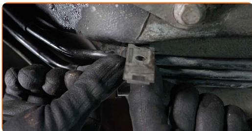
**16** Installez les brides de retenue des fixations des tuyaux du filtre à carburant.
