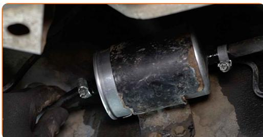
**19** Serrez les colliers de fixation des tuyaux de filtre à carburant. Utilisez une douille n° 7. Utilisez une clé à cliquet.
