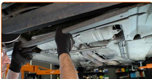
**22** Vissez les fixations de la protection plastique de la carrosserie de la voiture. Utilisez une douille n° 10. Utilisez une clé à cliquet.
